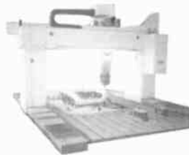
图3 使用Digimill-40L数控仿形铣床代替三坐标测量仪
