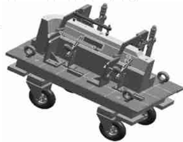
图1 检具的主要结构示意图
